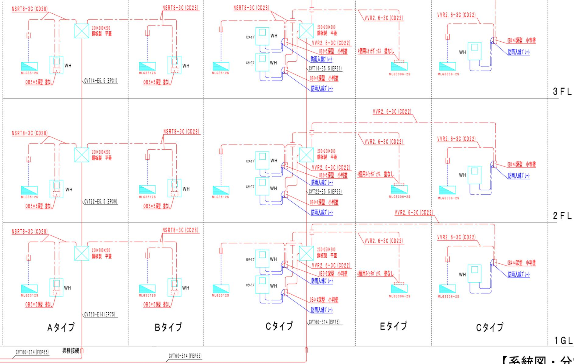
【系統図・分電盤図 例】
